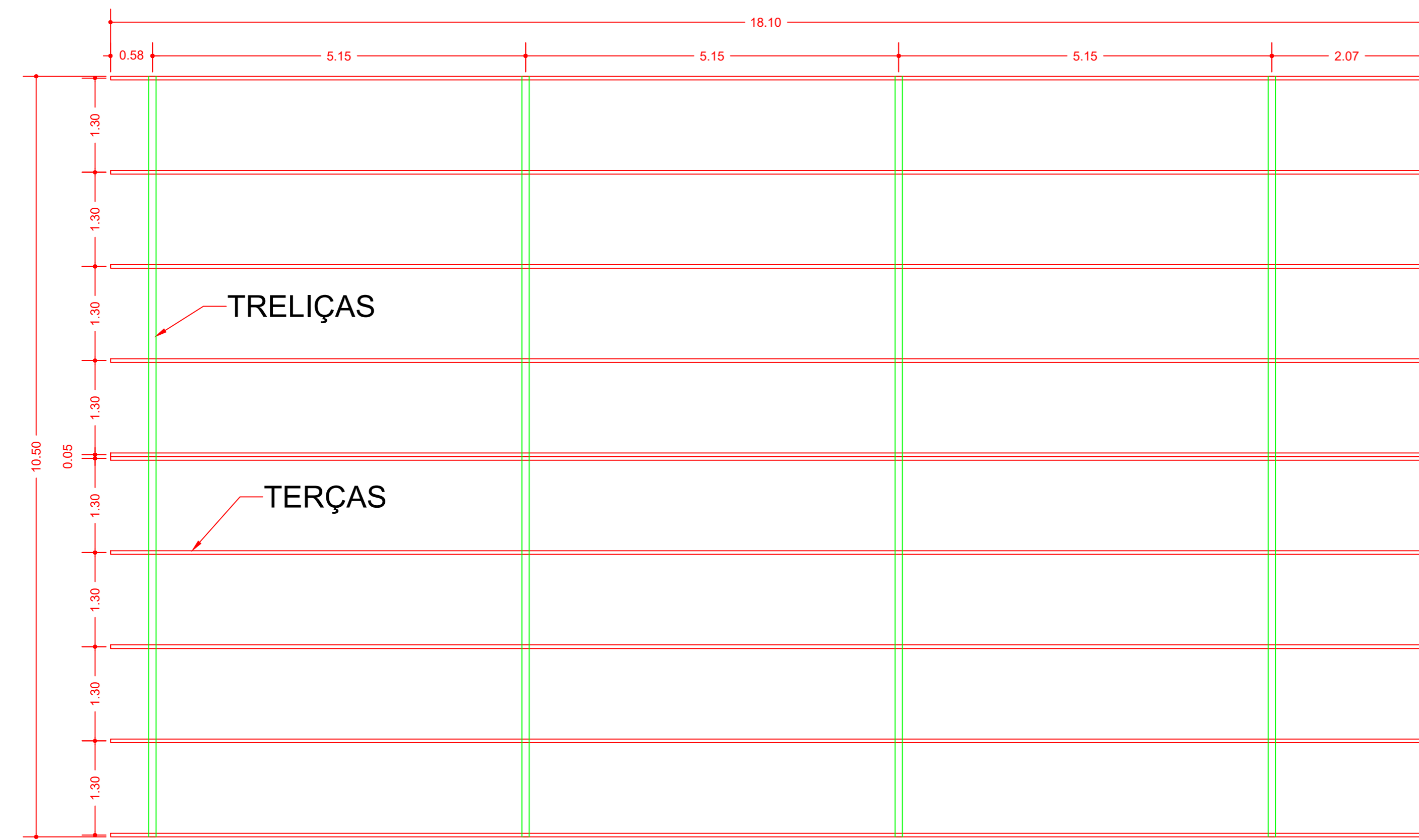
PLANTA - ESTRUTURA METÁLICA ESC.: 1:50
